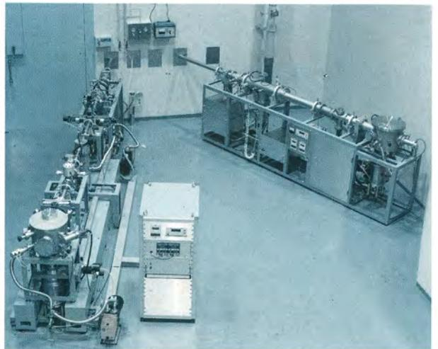
大阪工業技術試験所のイオン注入装置
