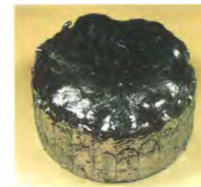
ナノテクノロジーから生まれた超高純度鉄 (科学技術振興事業団のプロジェクトで東北大学の安彦氏らが開発した純度99.9989%以上の10kg 超高純度鉄インゴット)
