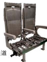
図4 高速鉄道車両用腰掛フレームの部品構成
