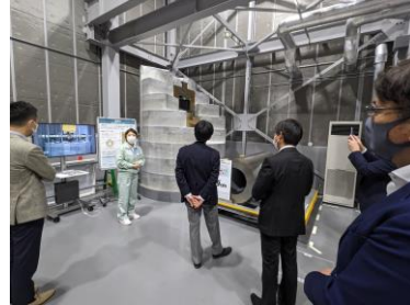
人工バリアの実物(金属容器・緩衝材)
