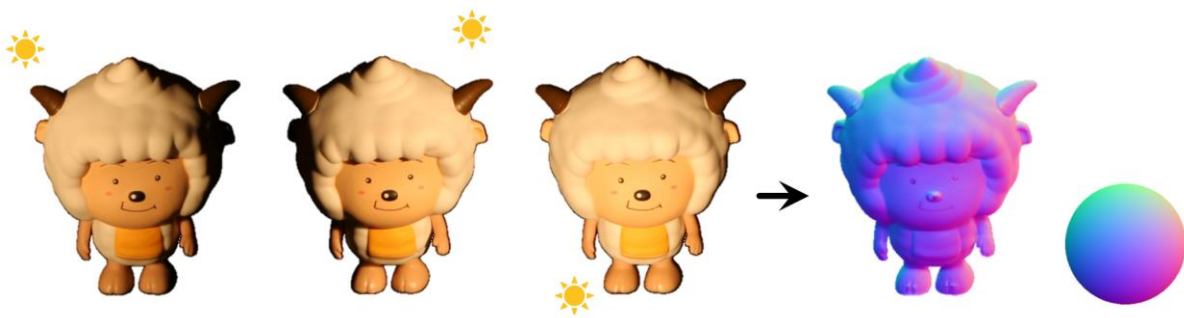
異なる光源下で撮影された画像 図2 照度差ステレオ法による法線マップの推定 (参照球は法線と色との関係を示す)
