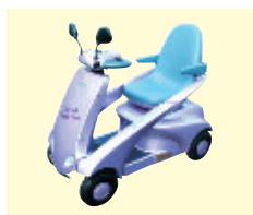
燃料電池カート実証機
