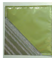
ポリイミドフィルム(上)を何枚も重ねて縫ったのがサーマルブランケット(左)
