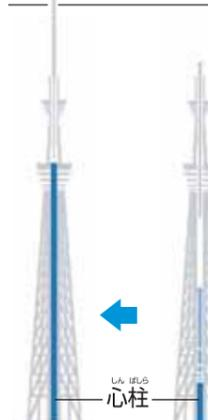
このゆれを弱める役目(制振)をするのが「心柱」と呼ばれているものです。鉄筋コンクリート造の円筒で、ゆれを打ち消す重りの役目をします。ゲイン塔の組み立てに使ったタワー中央部のスペースに、連続して「コンクリート」を流し込み、短時間で心柱をつくる方法を「スリップフォーム工法」といいます。
