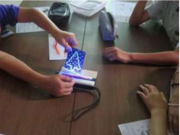
蛍光の実験により目に見えない紫外線を確認する
