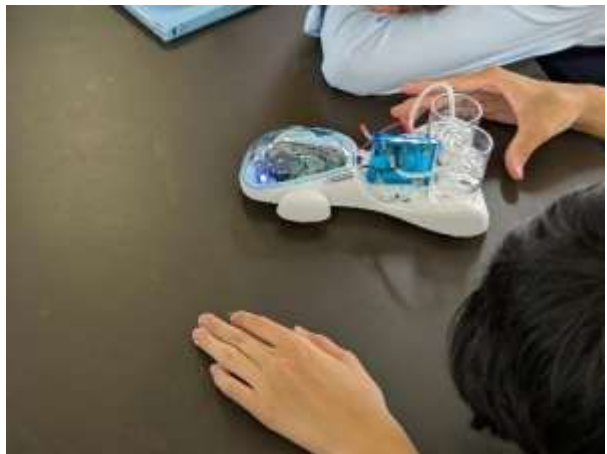
燃料電池カーによる水の電気分解と 燃料電池での電力供給実験
