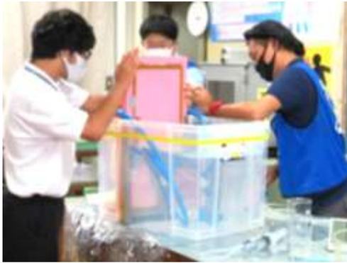
プラスチック衣装ケースの中に木製ドアを付け、片側に水をためる。水の無い側からドアを押して、水圧を確認する。
