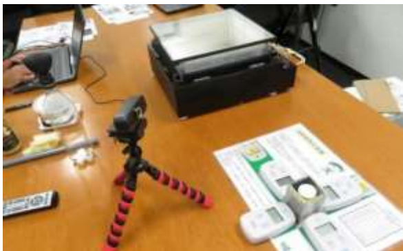
霧箱、測定器実験のセッティング
