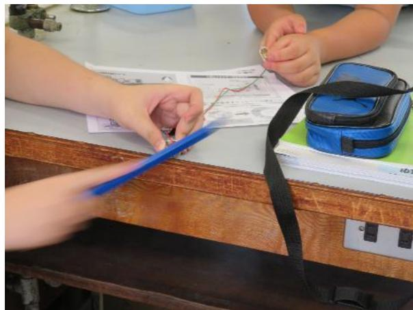
モーターを人力で回転させ豆電球を点灯させる実験
