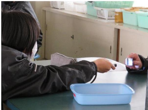
自転車の反射板による再帰性反射の実験
