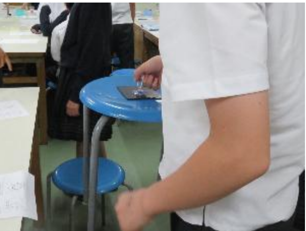
大気圧が吸盤を押さえる力
