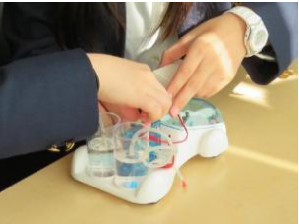
水の電気分解、燃料電池カー
