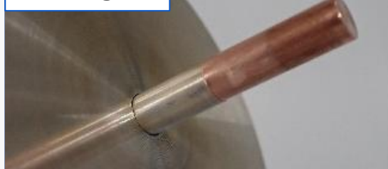
図：H 2 プラズマ（上）、プラズマ処理で接合されたCu/Ag棒（下）
