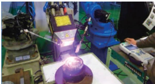
富士高周波工業(株)は 1956 年創業の鋼材の熱処理受託企業で、高周波誘導コイルで鋼材を加熱した後、水焼入れ・焼戻処理を行って主に鋼材の耐摩耗性向上のための硬化処理を行っています。
