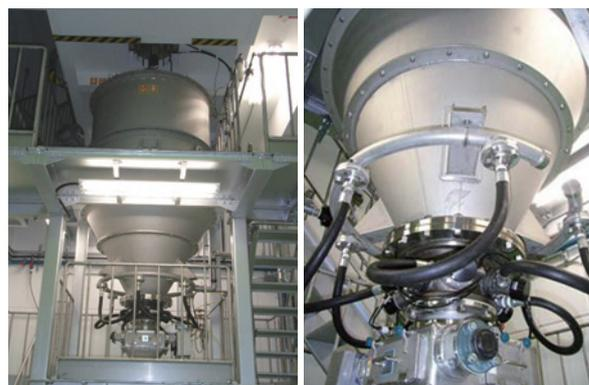
図3. 硝子粉末攪拌装置の外観
