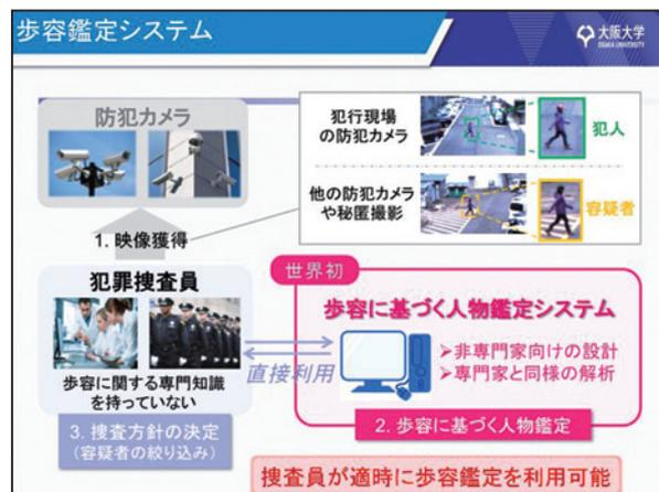
歩容認証技術も時代の流れの中で深層学習という手法が使われ出しました。我々も深層学習を使ったシステムを作っています。認証精度は深層学習を使うことで、向上してきています。1万人の歩容のデータを全部で14方向から観察したデータをつかると、認証精度がすごくよくなります。深層学習の手法と従来手法とを比較すると、データ量が増えたことで深層学習を使って性能を一気に向上させることができました。今、認証精度で1:N認証では、同じ向きであれば、99.4%程度の精度で同一人物を抽出することが可能となっています。ベンチマークである従来手法と比較しても、深層学習をベー
