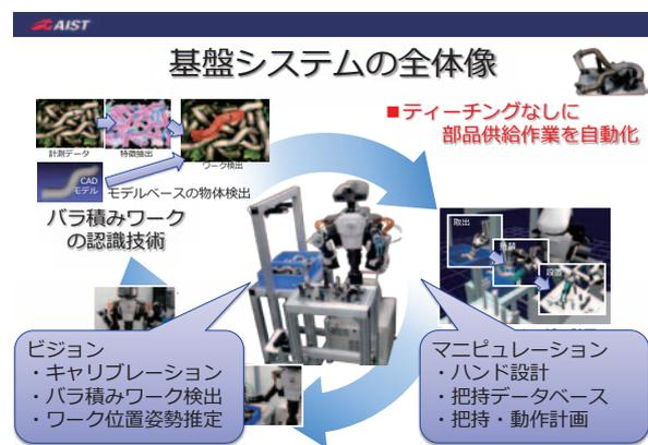
システムの概要は、「ランダムに入った部品をカメラで見て、ロボットが治具に組み付ける」というものですが、ここで必要な基盤技術は、
