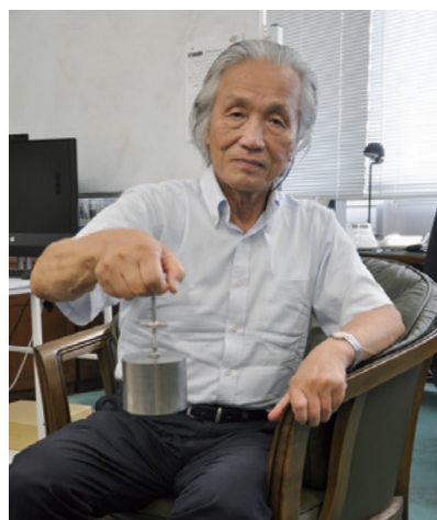
僅か1グラムのネオジム磁石(1円玉大)の磁力で3キロもの分銅のおかけのような鉄の塊を持ち上げている様子
