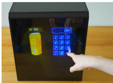
図3 非接触空中スイッチによるテンキーの例
