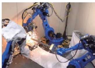
レーザー光浴断機、ロボットアーム、溶けカスを受けるアーム。このセットをモニター越しに遠隔で動かす
